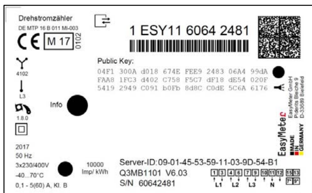
Abbildung 3: Leistungsschild des Zählers (beispielhaft)
